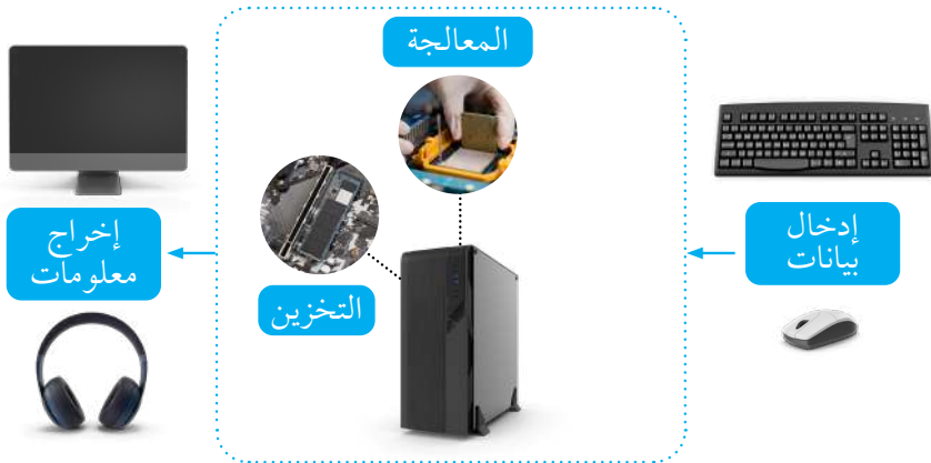
الشكل (1-1): رسم توضيحي لمبدأ عمل جهاز الحاسوب.
