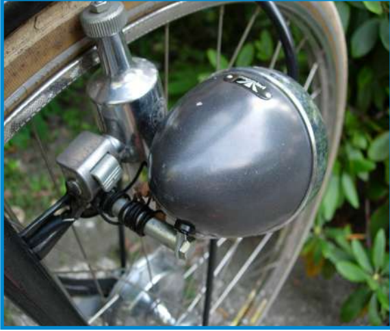
يتصل المولد الكهربائي بعجلة الدراجة
