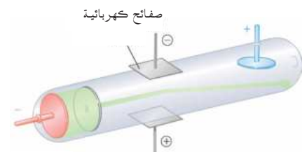
تأثر الاشعة الكاثودية بالصفائح الكهربائية.
