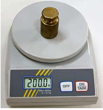
■ الشكل 6-1 يختبر الضبط عن طريق قياس قيمة معلومة.
