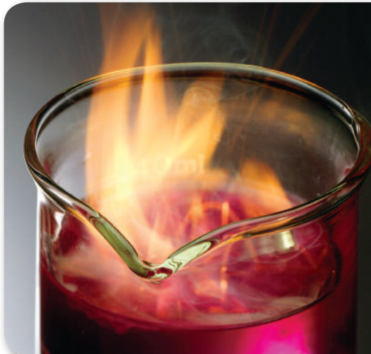
الشكل 5-9 يتفاعل فلز البوتاسيوم بشدة مع الماء مطلقًا كمية كبيرة من الحرارة كافية لإشعال غاز الهيدروجين الناتج واحتراقه.
