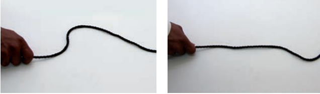
■ الشكل 1-7 تم التقاط هاتين الصورتين بفارق زمني 0.20 s. وخلال هذه الفترة تحركت القمة 0.80 m. فتكون السرعة المتجهة للموجة 4.0 m/s.
