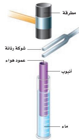
الشكل 5-2 يغير رفع الأنبوب أو إنزاله طول عمود الهواء، ويكون الصوت عالٍ عند حدوث رنين بين عمود الهواء والشوكة الرنانة.
