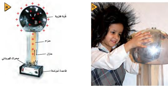
■ الشكل 1-6 في مولد فان دي جراف (a)، تنتقل الشحنتات إلى الحزام المتحرك عند النقطة A، ثم تنتقل من الحزام المتحرك إلى القبة الفلزية عند الموضع B. ويبدّل المحرك الكهربائي الشغل اللازم لزيادة فرق الجهد الكهربائي. وعندما يلمس شخص معزول قبة مولد فان دي جراف تكون النتائج مثيرة (b).
