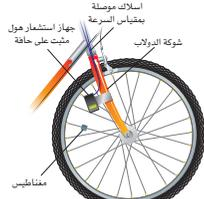
يستخدم المجس الذي يعمل وفق تأثير هول في مقياس سرعة الدراجة الهوائية لتحديد سرعتها
