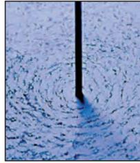
**الشكل 10-4** ينمكس اتجاه المجال المغناطيسي الناتج عن مرور تيار خلال سلك موصل مستقيم عندما ينعكس اتجاه التيار المار به (a). ويحدد اتجاه المجال المغناطيسي الناتج عن سلك مستقيم يحمل تيارًا باستخدام القاعدة الأولى لليد اليمنى (b).
