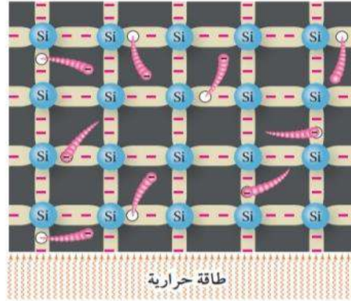
الشكل (39): الإلكترونات الحرة والفجوات في بلورة السليكون.
