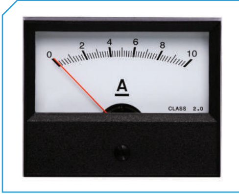
شكل (11): جهاز الأميتر
