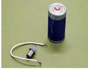
حتى ينتج تيار كهربائي في سلك الدارة الكهربائية. نحتاج إلى مصدر طاقة لدفع الإلكترونات، بحيث يكون طرفا السلك أحدهما سالب الشحنة والطرف الآخر موجب الشحنة، ليعطي الفرق بين طرفي السلك نوعاً من الضغط الكهربائي يحرك الإلكترونات بين طرفي الدائرة منتجاً التيار، ويعطي الطاقة للإلكترونات للتحرك من طرف السلك السالب تجاه طرفه الموجب.
