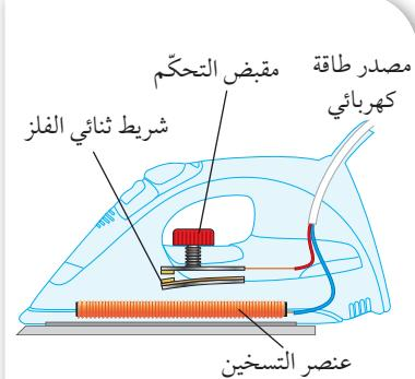
الشكل (16): يستخدم الشريط الثنائي الفلز في منظم الحرارة في المكواة الكهربائية.
