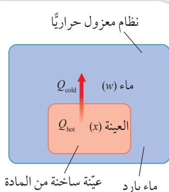
الشكل (6): في تجربة قياس السَّعَة الحرارية النوعية، تتوضع عيّنة ساخنة من مادة مجهولة السَّعَة الحرارية النوعية في ماء بارد، في وعاء يعزل النظام عن المحيط الخارجي.
