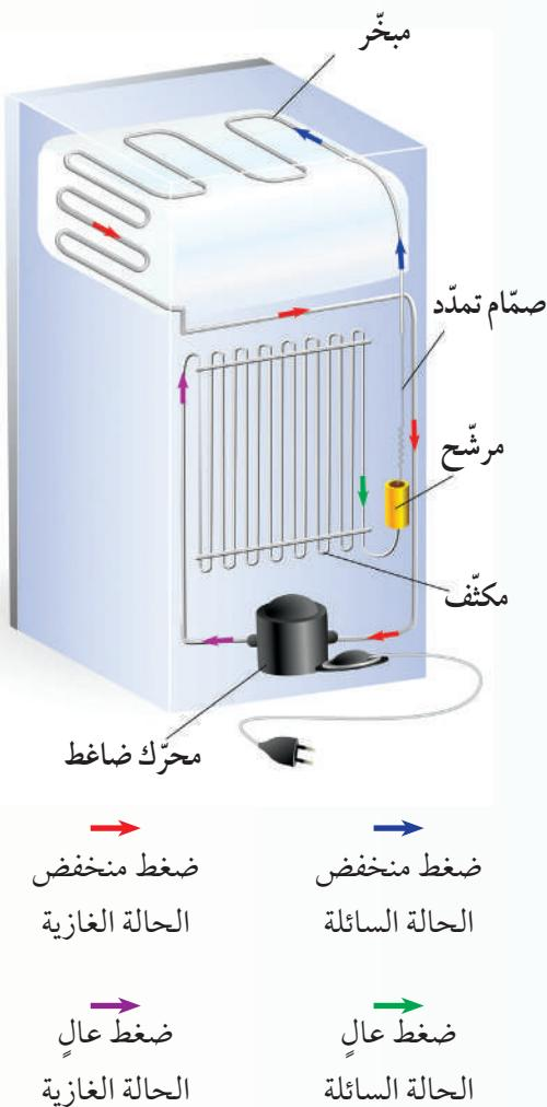
**المرحلة الأولى:** تكون درجة حرارة سائل التبريد أقل من درجة حرارة الهواء داخل الثلاجة، فيكتسب السائل طاقة من داخل الثلاجة، وترتفع درجة حرارته، وتستمر هذه العملية إلى أن يتحول سائل التبريد إلى الحالة الغازية.
