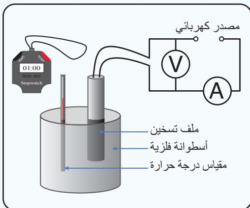
**المواد والأدوات:** مصدر كهربائي مناسب (12 V)، ثلاثة أسطوانات من فلزات مختلفة (المنيوم، رصاص، نحاس) مثل المبينة في الشكل المجاور، مقياس درجة حرارة، ساعة توقيت، ميزان رقمي، أسلاك توصيل، فولتميتر، أميتر، ملف تسخين.
