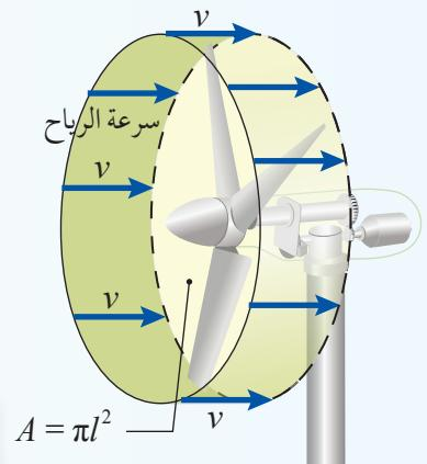
حجم الهواء المار عبر المستوى الذي تشكّله شفرات التوربين يساوي حجم أسطوانة مساحة مقطعها العرضي ( $A$ )، وطولها في الثانية الواحدة يساوي سرعة الرياح ( $v$ ).
