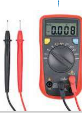
الشكل (11): أ. مقياس رقمي. ب. مقياس ذو تدريج تناظري. ج. مسطرة طرفها تالف.
