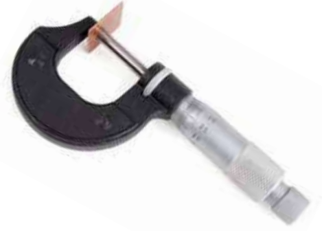
الشكل (3): قياس سُمْك صفيحة باستخدام الميكروميتر.
