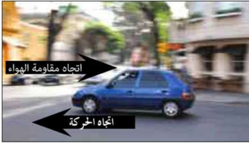
شكل (٥): تأثير مقاومة الهواء على حركة السيارة
